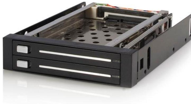
Esta bahía de intercambio en caliente para unidades de disco duro SATA de 3.5" permite instalar dos unidades de disco duro SATA HDD o SSD de 2.5" en una bahía de unidad de disco floppy de 3.5" disponible/no utilizada.
