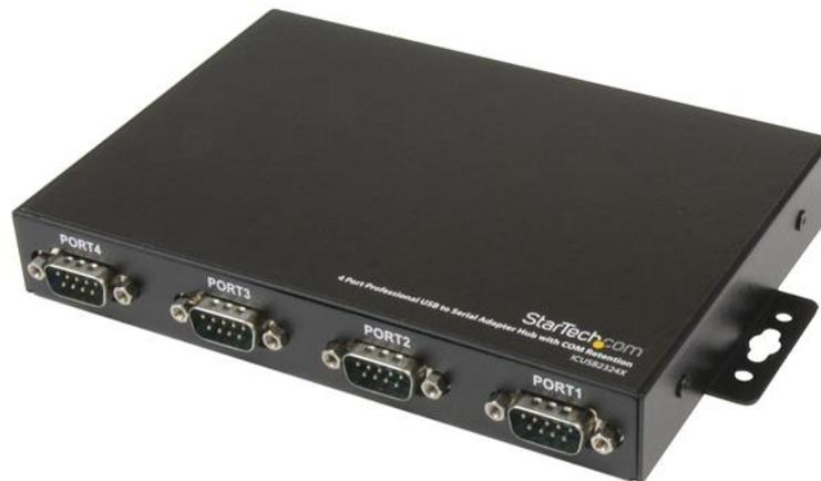
Este Adaptador Profesional USB a Puerto Serie convierte un único puerto USB en 4 Puertos Serie RS232, permitiendo conectar hasta cuatro dispositivos serie simultáneamente. Una vez conectado, el adaptador retiene los valores designados del puerto serie COM, por lo que en caso de que se desconecte y se vuelva a conectar al ordenador principal, los mismos valores serán reasignados automáticamente al puerto provisto por el adaptador.
