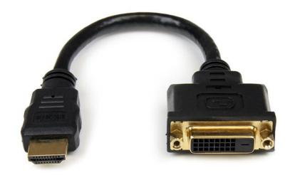
El Adaptador Cable HDMI® a DVI, HDDVIMF8IN dispone de un conector HDMI macho y un conector DVI-D hembra que permiten realizar una conexión bidireccional entre dispositivos con capacidad HDMI y dispositivos con capacidad DVI-D a fin de superar cuestiones de comptatibilidad.
