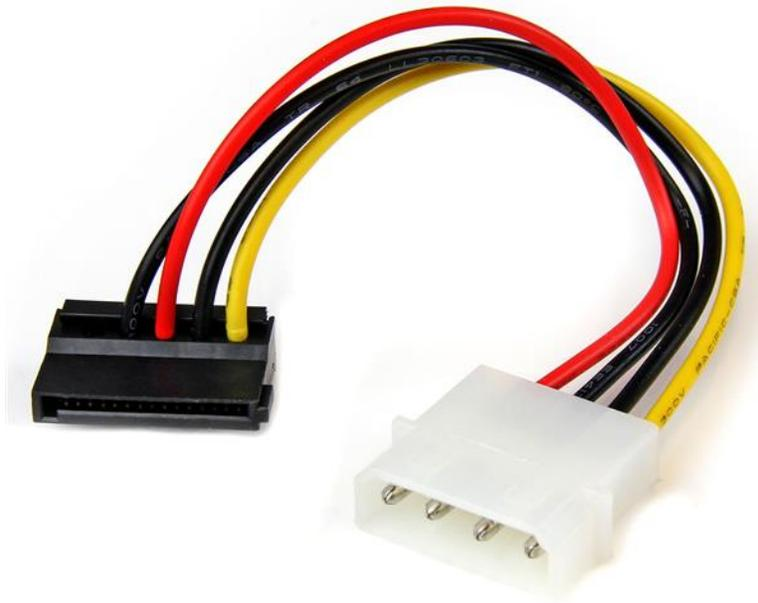
El adaptador para Molex a alimentación SATA a 90 grados SATAPOWADPL incluye un conector Molex (LP4) macho de 4 pines y un conector (hembra) de alimentación SATA a 90 grados, en ángulo izquierdo, lo cual permite la alimentación de una unidad de disco duro serial ATA a partir de una conexión LP4 convencional, y evita gastar en actualizar el computador a un modelo con compatibilidad con los discos duros SATA.
