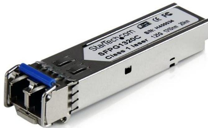
El módulo SFP para transceptor SFPG1320C de fibra óptica Cisco® Compatible Gigabit SM LC, 20 km, está fabricado para ajustarse a las normas MSA ("Multi-Sourcing Agreement", acuerdo multifuente) y es una alternativa económica para agregar, reemplazar o actualizar un puerto LC de modo único en un equipo de red Gigabit de fibra óptica o un conversor de medios de fibra óptica.
