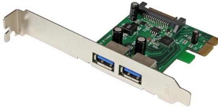
La tarjeta PCI Express USB 3.0 de 2 puertos, modelo PEXUSB3S24, permite agregar dos puertos USB 3.0 a cualquier sistema con PCI Express disponible, con un conector SATA opcional de alimentación eléctrica que ofrece hasta 900 mA de potencia por puerto a los dispositivos con alimentación de bus USB 3.0 (500 mA, en el caso de USB 2.0).
