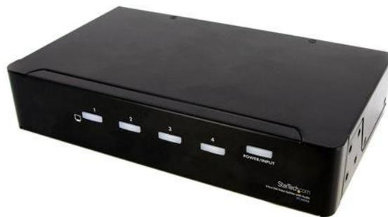
El Divisor de Video DVI, ST122DVIA permite compartir la misma fuente de audio y video DVI en cuatro pantallas y actúa como amplificador de señal que posibilita ubicar sus monitores DVI a una distancia de hasta 10 m de la computadora o fuente de señal DVI.
