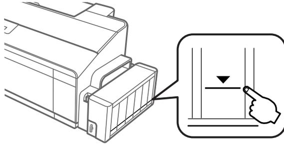
**Nota:** La impresora L1300 tiene cinco tanques de tinta, incluyendo dos tanques de tinta negra. Compruebe que los niveles de tinta en ambos tanques de tinta negra estén por encima de las líneas inferiores de los tanques de tinta.
