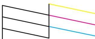
**Necesita limpiar el cabezal de impresión.**
