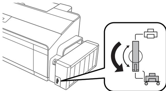
9. Desenganche la unidad de tanques de tinta y acuéstela, luego compruebe que los tapones estén instalados firmemente en los tanques de tinta.
