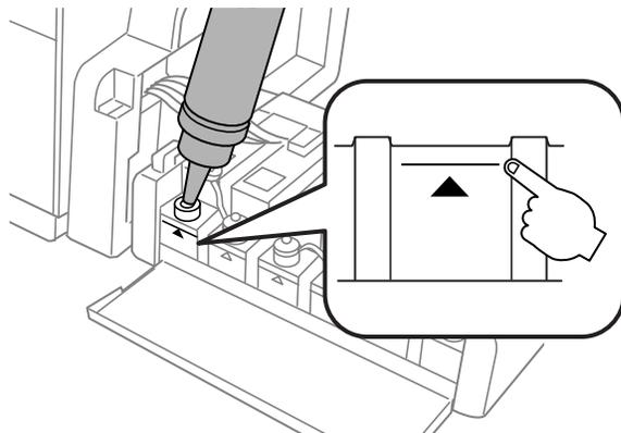
8. Si queda tinta en la botella después de llenar el tanque, coloque el tapón en la tapa de la botella firmemente y guarde la botella de tinta para utilizarla después.
