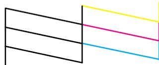
**Necesita limpiar el cabezal de impresión.**
