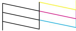
**Necesita limpiar el cabezal de impresión.**
