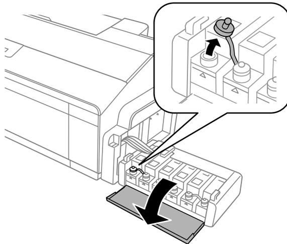
**Nota:** Asegure que el color de la tinta coincida con el color del tanque de tinta que desea rellenar y luego solo retire el tapón de ese tanque. Tenga cuidado de no derramar la tinta.
