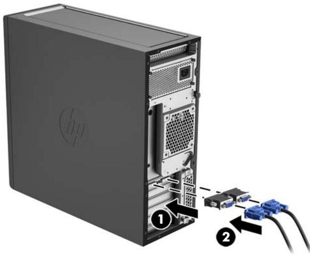
2. Conecte los otros extremos de los cables del monitor a los monitores.
