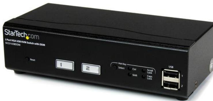
El switch conmutador KVM con 2 puertos USB VGA, modelo SV231USBDDM, permite controlar 2 computadoras con VGA equipadas con USB, mediante un solo conjunto de periféricos, a resoluciones VGA de alta definición de hasta 1920x1440.
