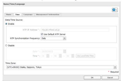
De forma predeterminada, LinkStation ajusta su reloj automáticamente mediante un servidor NTP predeterminado. Este servidor NTP es propiedad de Internet Multi Feed Inc. Para obtener más información, visite http://www.jst.mfeed.ad.jp.
