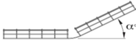
Para realizar curvas en subida o bajada con radios de curvatura más amplios, corte dos o más partes laterales.
