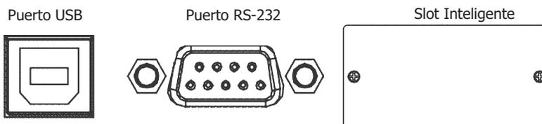
Para tener controlado el UPS desde su PC, conecte el cable de comunicación desde la PC a uno de los puertos USB / RS-232. Con el software instalado en su PC, usted puede programar el encendido / apagado del UPSI.
