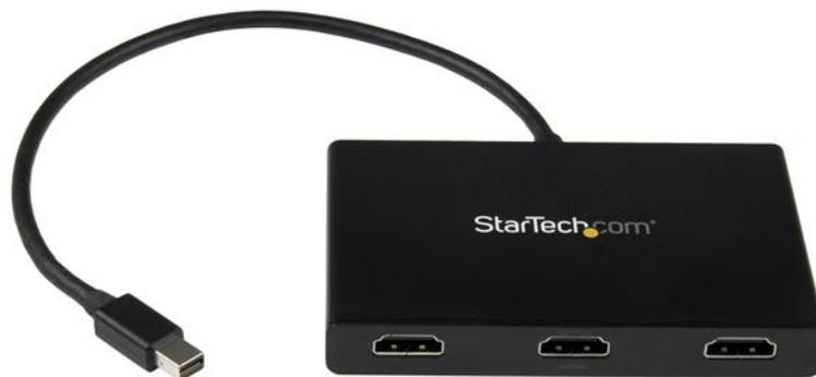
Este concentrador MST le permite conectar tres monitores HDMI a su ordenador portátil equipado con Mini DisplayPort. MST funciona en cualquier dispositivo Windows® compatible con DisplayPort 1.2, como los modelos Think Pad® de Lenovo™ y Surface™ de Microsoft®. Cuando el concentrador MST está conectado a versiones anteriores de DisplayPort, como DP 1.1, funciona como multiplicador de vídeo.
