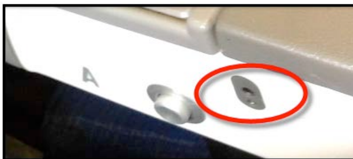
Ilustracja 1.9. Wtyczki wejściowe w fotelu samolotowym (podłokietnik)
