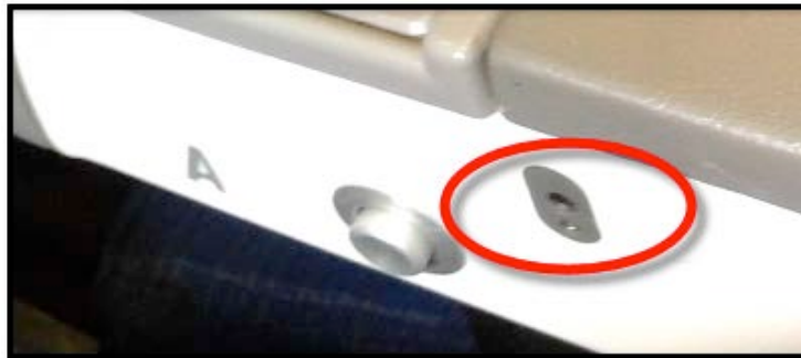
図 1.9 - 機内シート (アームレスト) の入カジャック
