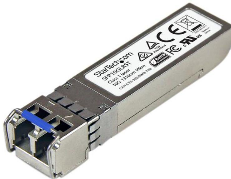
El modelo SFP10GLRST es un módulo transceptor por fibra óptica compatible con Cisco SFP-10G-LR, diseñado, programado y probado para su funcionamiento con enrutadores y conmutadores de la marca Cisco®. Ofrece conectividad confiable a 10GbE a través de cableado de fibra, para redes compatibles con 10GBASE-LR, a una distancia máxima de hasta 10km.
