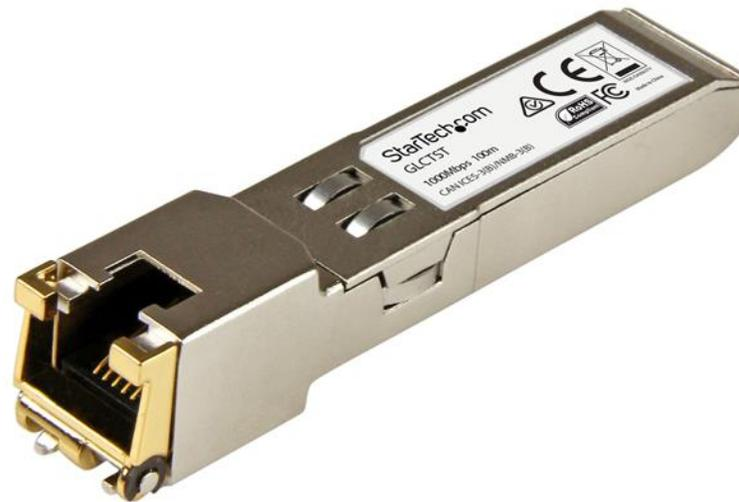
El modelo GLCTST es un módulo transceptor por cobre compatible con el modelo GLC-T de Cisco, diseñado, programado y probado para su funcionamiento con enrutadores y conmutadores de la marca Cisco®. Ofrece conectividad 1GbE confiable a través de cable de cobre para redes compatibles con 1000BASE-T, con una distancia máxima de hasta 100m.
