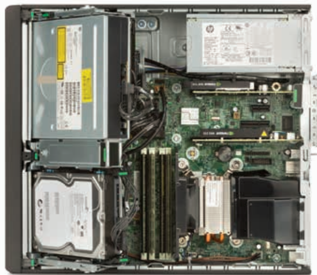
Estación de trabajo HP Z230 SFF Vista interna.
