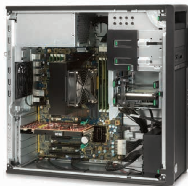
Estación de trabajo HP Z440. Vista interna.
