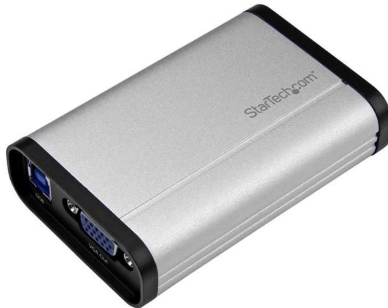
Este dispositivo de captura de vídeo VGA a USB graba vídeo VGA en su ordenador. Su resistente caja de aluminio está fabricada para que el dispositivo se utilice en una ubicación fija o en otras ubicaciones. Incluye una entrada independiente de audio de 3,5mm para la grabación de audio o voz de acompañamiento, así como un puerto VGA pass-through para la conexión de un monitor, a fin de revisar el vídeo capturado.
