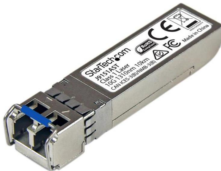
El modelo J9151AST es un módulo transceptor por fibra óptica, compatible con el modelo J9151A de HP, diseñado, programado y probado para su funcionamiento con enrutadores y conmutadores de la marca HP®. Ofrece conectividad confiable a 10GbE a través de cableado de fibra, para redes compatibles con 10GBASE-LR, a una distancia máxima de hasta 10km.
