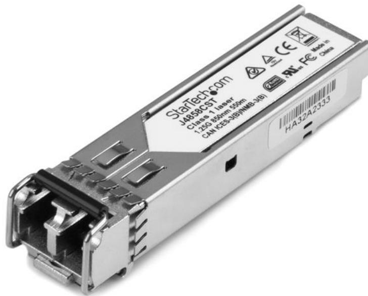
El modelo J4858CST es un módulo transceptor por fibra óptica, compatible con el modelo J4858C de HP, diseñado, programado y probado para su funcionamiento con enrutadores y conmutadores de la marca HP®. Ofrece conectividad confiable a 1GbE a través de cableado de fibra, para redes compatibles con 1000BASE-SX, a una distancia máxima de hasta 550m.
