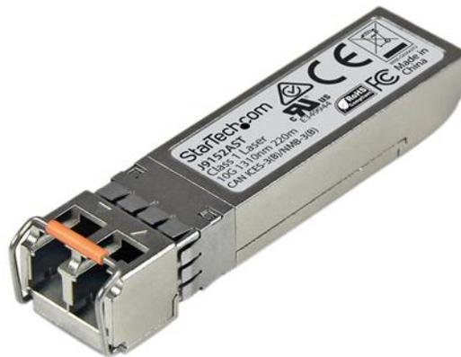
El modelo J9152AST es un módulo transceptor por fibra óptica, compatible con el modelo J9152A de HP, diseñado, programado y probado para su funcionamiento con enrutadores y conmutadores de la marca HP®. Ofrece conectividad confiable a 10GbE a través de cableado de fibra, para redes compatibles con 10GBASE-LRM, a una distancia máxima de hasta 220m.
