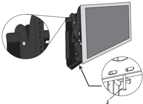
6.- Coloque y apriete los dos tornillos (J) en las barras (B) para ajustar perfectamente el movimiento horizontal.
