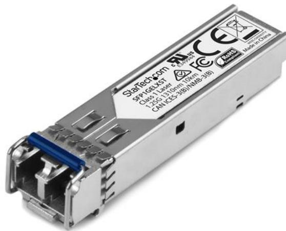
El modelo SFP1GELXST es un módulo transceptor por fibra óptica, compatible con el modelo SFP-1GE-LX de Juniper, diseñado, programado y probado para su funcionamiento con enrutadores y conmutadores de la marca Juniper®. Ofrece conectividad 1GbE confiable a través de cable de fibra óptica para redes compatibles con 1000BASE-LX, con una distancia máxima de hasta 10km.
