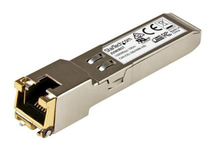
El modelo JD089BST es un módulo transceptor por cobre, compatible con el modelo JD089B de HP, diseñado, programado y probado para su funcionamiento con enrutadores y conmutadores de la marca HP®. Ofrece conectividad confiable a 1GbE a través de cableado de fibra, para redes compatibles con 1000BASE-T, a una distancia máxima de hasta 100m.
