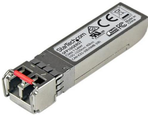
El modelo SFP10GERST es un módulo transceptor por fibra óptica compatible con el modelo SFP-10G-ER de Cisco, diseñado, programado y probado para su funcionamiento con enrutadores y conmutadores de la marca Cisco®. Ofrece conectividad fiable a 10GbE a través de cableado de fibra, para redes compatibles con 10GBASE-ER, a una distancia máxima de hasta 40km.
