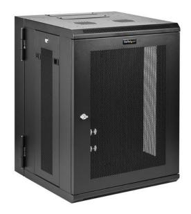
Este armario 15U para racks de servidores o redes le permite instalar equipos compatibles con la norma EIA-310 en una pared, en una caja segura con puerta trasera abisagrada, para facilitar el acceso a su equipo. La caja permite una profundidad ajustable de montaje, entre 6,1cm a 50,8cm, lo cual constituye una solución resistente de almacenamiento para su equipo de montaje en rack.
