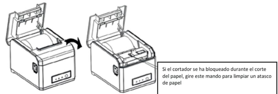
Nota: No forzar la tapa para evitar daños irreversibles en el cabezal de impresión y en el cortador.
