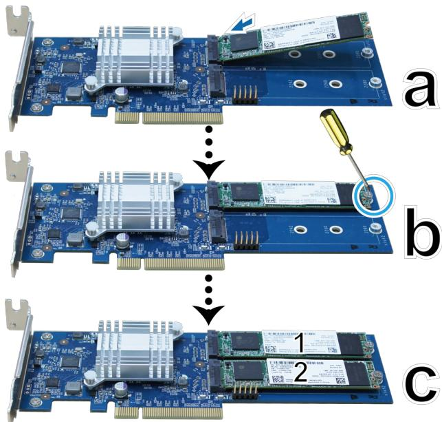
**4 Instale la tarjeta adaptadora M2D17:**
