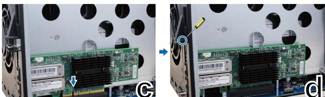
**5** Vuelva a colocar la cubierta superior y apriete los 6 tornillos que quitó en el paso 2.
