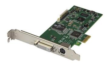
Esta tarjeta de captura de vídeo PCIe le permite grabar vídeo HD de 1080p y audio estéreo de 2 canales (HDMI/RCA) en su sistema informático. Con varias entradas de vídeo, como HDMI, DVI, VGA y vídeo por componentes, esta tarjeta de captura permite grabar contenido original de casi cualquier dispositivo.
