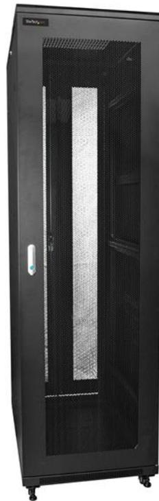
Este armario para racks de servidores ofrece 42U de espacio de almacenamiento seguro para guardar dispositivos estándar de 19" (48cm) aptos para montaje en rack (compatibles con la norma EIA-310), como servidores Dell, HP e IBM, así como equipos de telecomunicaciones y audiovisuales (A/V). El rack de servidores constituye una solución económica y a la vez resistente, con capacidad total de 907kg de peso.
