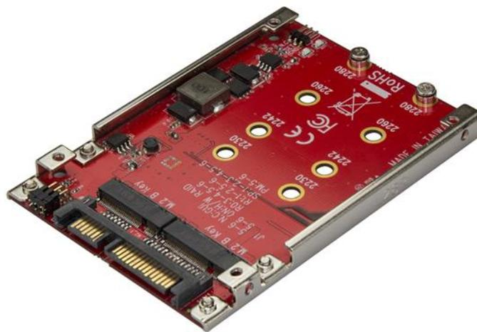
Amplíe el rendimiento de su sistema con la mejora de la capacidad, velocidad y seguridad del almacenamiento de sus datos. Este adaptador M.2 a SATA permite instalar dos unidades SATA M.2, en lugar de de una unidad SATA de disco, en una sola bahía de unidad de disco de 2,5", aumentar sus opciones de almacenamiento y configurar una potente matriz RAID.
