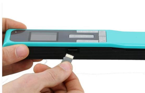
2. Introdúzcala en el adaptador de tarjetas microSD proporcionado.
