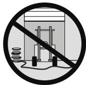
No coloque SafeCable en el suelo donde lo puede ser dañado accidentalmente.
