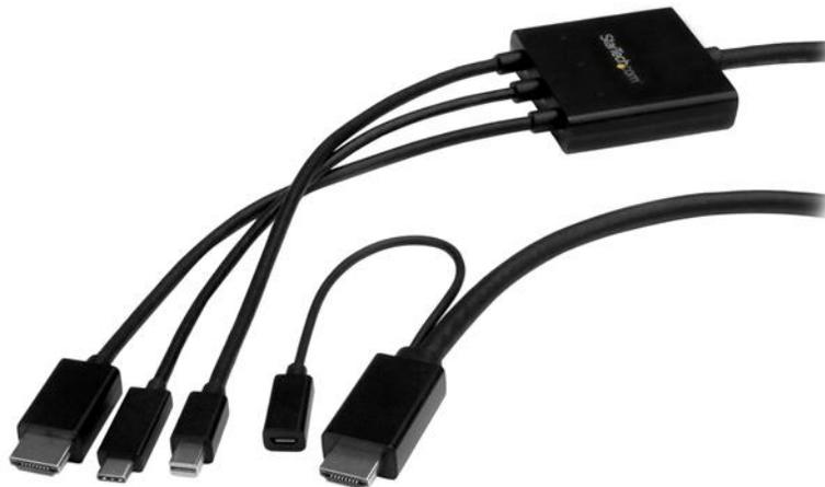
Este cable adaptador único le permite conectar casi cualquier ordenador portátil o de sobremesa con una pantalla o un proyector HDMI®. Es compatible con salidas USB-C™, HDMI y Mini DisplayPort de su ordenador y con resoluciones de vídeo de hasta 4K Ultra HD.
