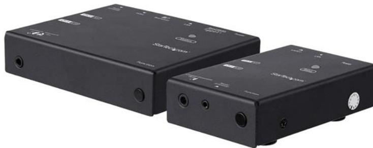
El kit extensor HDMI® a través de IP facilita la distribución de una señal HDMI a una pantalla remota, mediante su red de área local (LAN). También puede utilizar receptores adicionales (modelo ST12MHDLNHR, se adquieren por separado) para distribuir su señal HDMI a varias ubicaciones.
