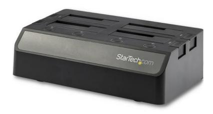
Esta estación de conexión HDD SATA de 4 bahías le permite acceder a hasta cuatro unidades de disco de estado sólido o discos duros simultáneamente a través de USB 3.1 (10Gbps) y realizar fácilmente el intercambio en caliente de las unidades. Ideal para profesionales de informática, la estación de conexión proporciona una amplia capacidad de datos y una rápida transferencia de ficheros, lo que contribuye a gestionar el flujo de trabajo de una forma más eficiente.
