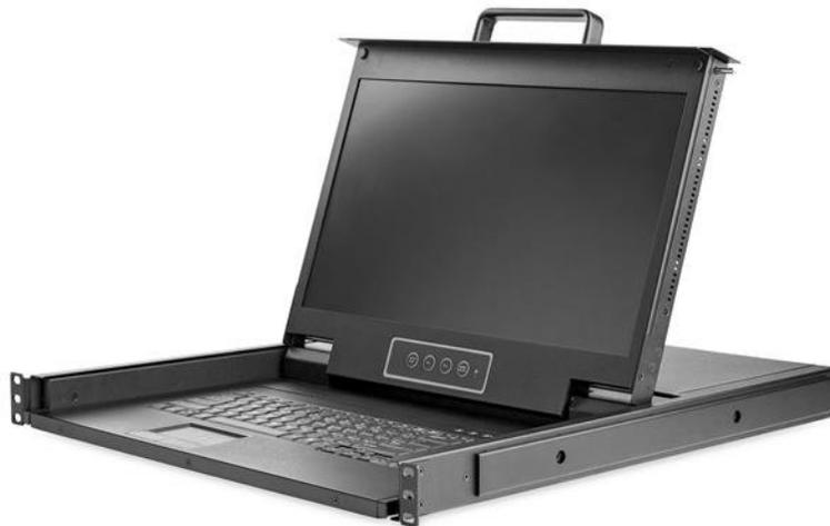
Dado que proporciona control centralizado de un solo ordenador o de decenas de servidores, esta consola KVM HD para montaje en rack le facilita además el acceso a su sistema y la visibilidad del sistema cuando está instalado en un rack o armario para servidores. Dado que está conectada a sus servidores a través de un conmutador KVM independiente (se adquiere por separado), la consola LCD se instala en un espacio de 1U, lo cual resulta eficaz y suficiente para el control total de la consola.
