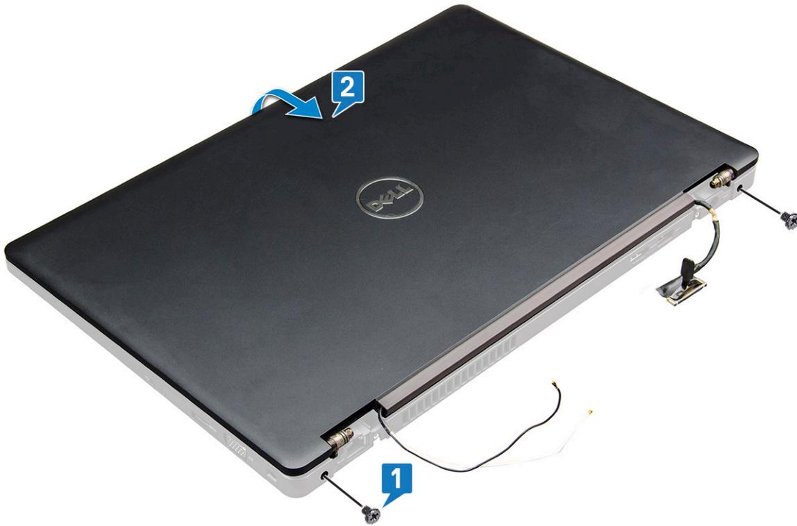
7 Deslice hacia arriba el ensamblaje de la pantalla para retirarlo de la del equipo.
