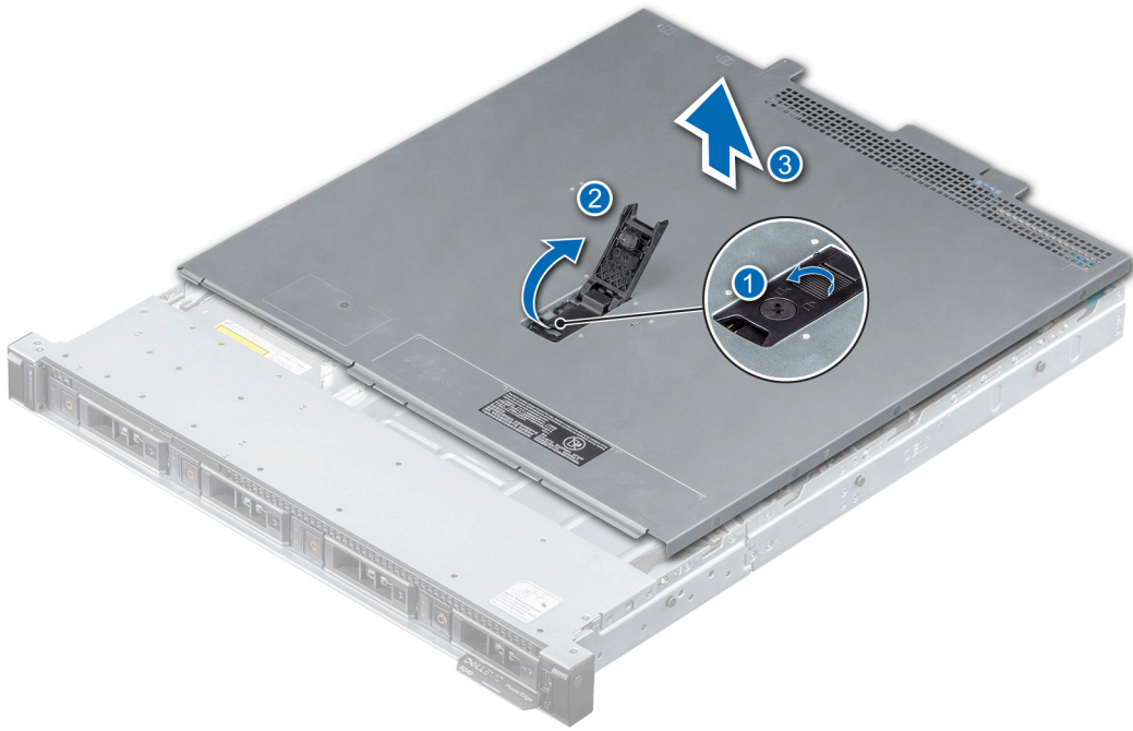
Figura 11. Extracción de la cubierta del sistema
