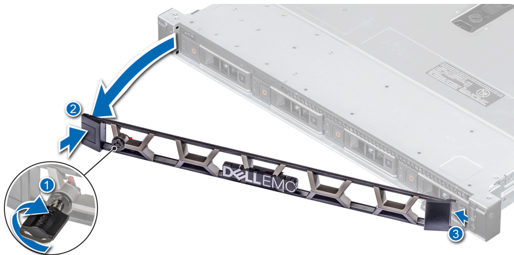
Figura 9. Extracción del bisel frontal
