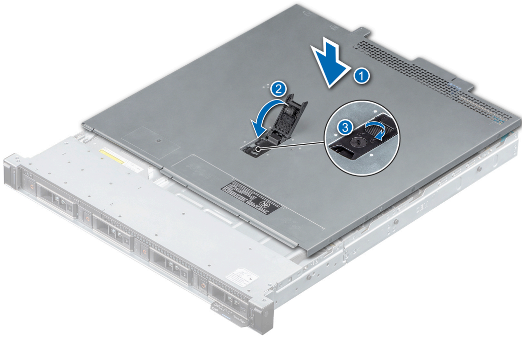
Figura 12. Instalación de la cubierta del sistema
