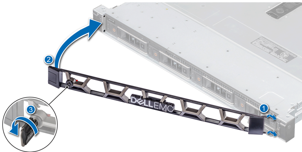
Figura 10. Instalación del bisel frontal
