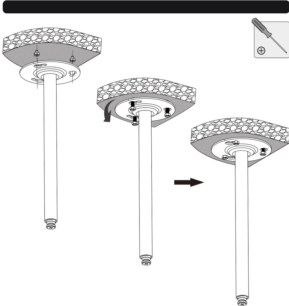
Cuelgue la placa de techo de modo de que los tornillos encajen en los orificios de la cerradura. Gire la placa de techo en su lugar. A continuación, apriete los tornillos.
