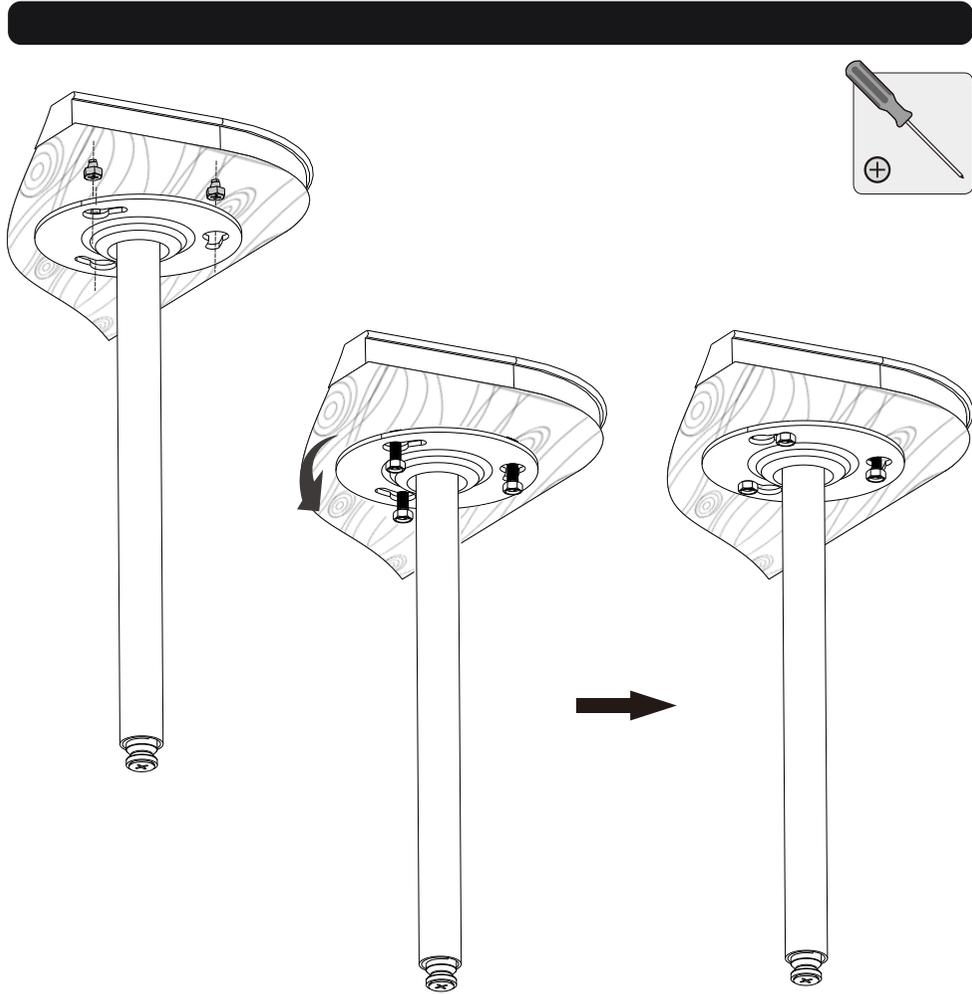
Cuelgue la placa de techo de modo de que los tornillos encajen en los orificios de la cerradura. Gire la placa de techo en su lugar. A continuación, apriete los tornillos.
