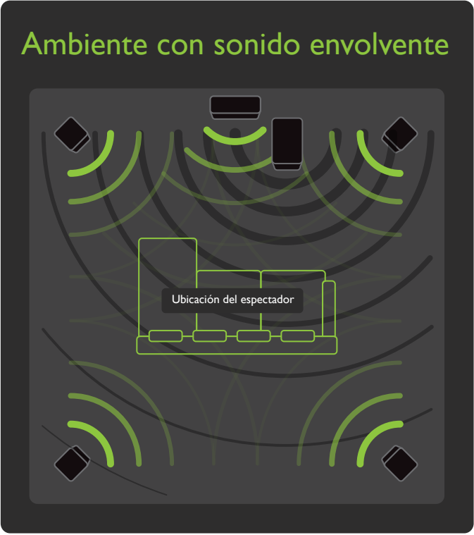
Disposición del sistema de parlantes de 5.1 canales
