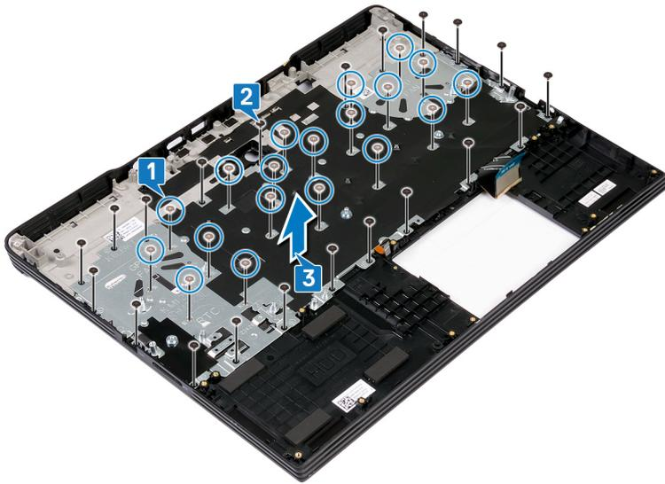
4 Levante el teclado, junto con su cable, para extraerlo del ensamblaje del reposamanos.
