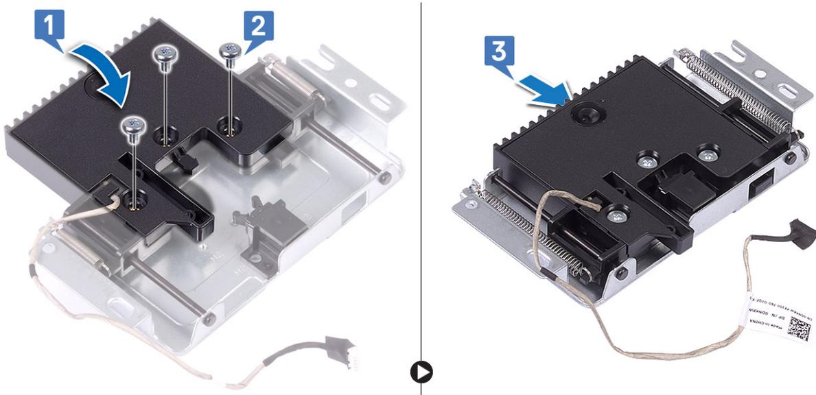
**4. Para instalar el ensamblaje de la cámara emergente:**
