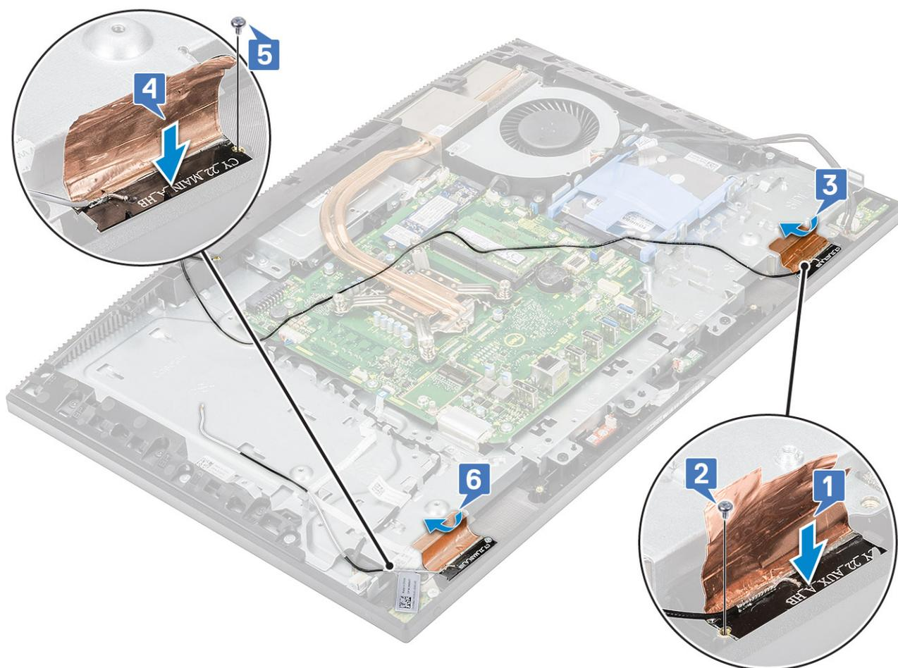
d) Pase los cables de la antena por las guías de colocación en la base del ensamblaje de la pantalla [1,2].
