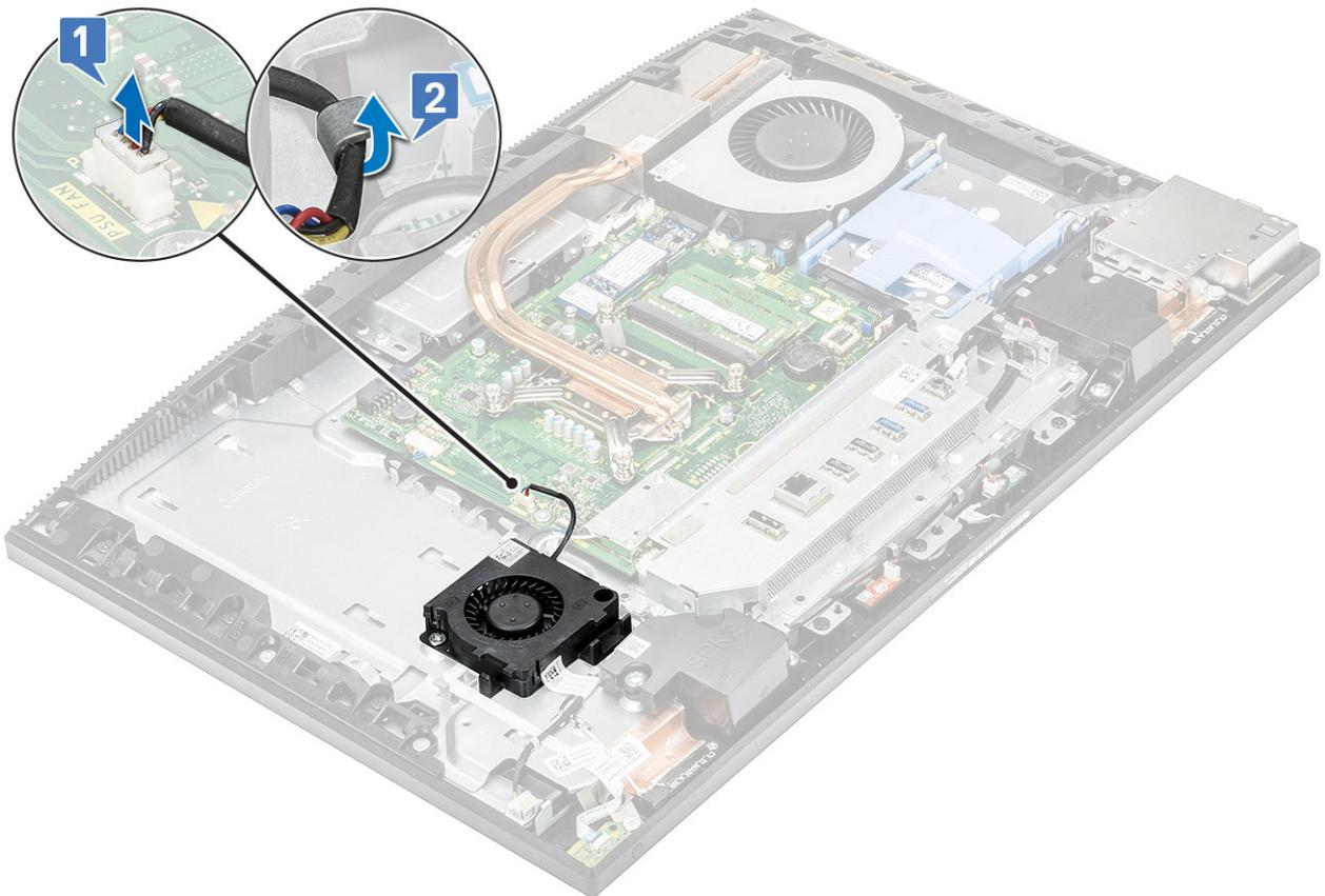
**4.** Para desconectar el ventilador de la PSU:
