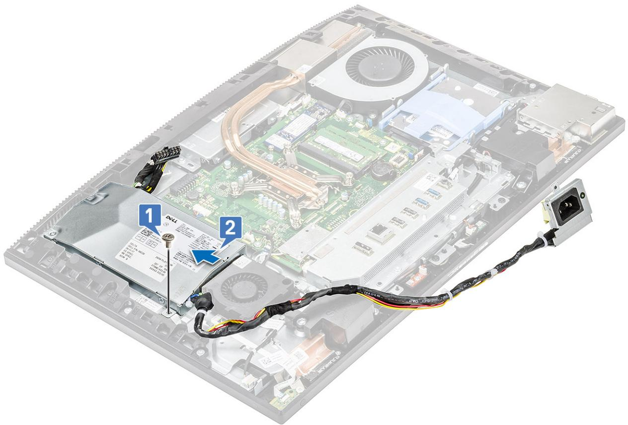
b) Deslice la PSU y levántela del chasis .
