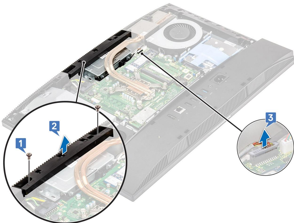
4. Para extraer el ensamblaje de la cámara emergente:
