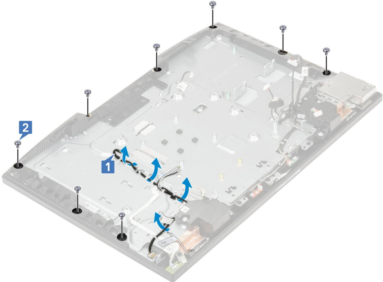
5. Coloque el sistema en posición vertical, sujete el panel de la pantalla y la base del ensamblaje de la pantalla, y suelte con cuidado el panel de la pantalla de la carcasa intermedia y de la base del ensamblaje de la pantalla [1].
