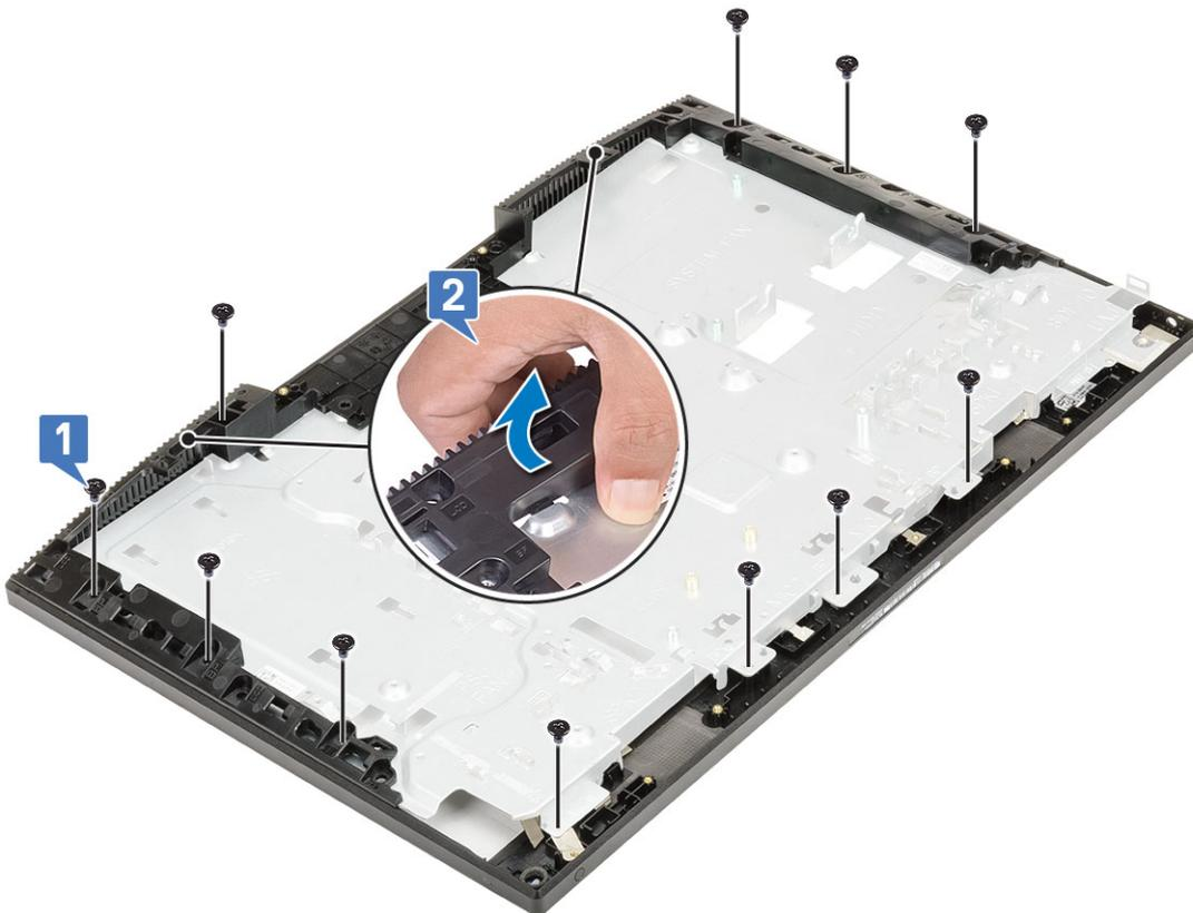
5. Levante la carcasa intermedia para separarla de la base del ensamblaje de la pantalla [1].
