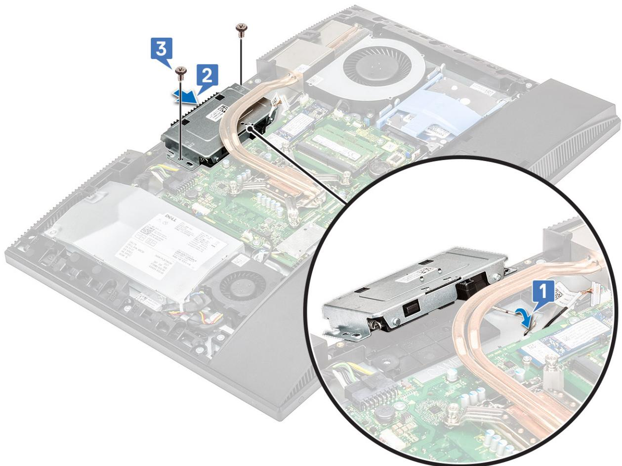
**5. Para volver a colocar la cubierta del ensamblaje de la cámara:**
