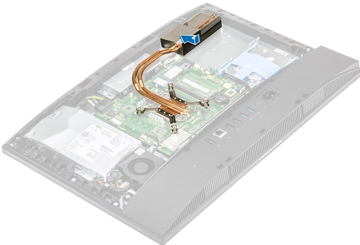
2. Ajuste los cinco tornillos cautivos en orden secuencial [1, 2, 3, 4, 5] para fijar el disipador de calor a la tarjeta madre del sistema y la base del ensamblaje de la pantalla.
