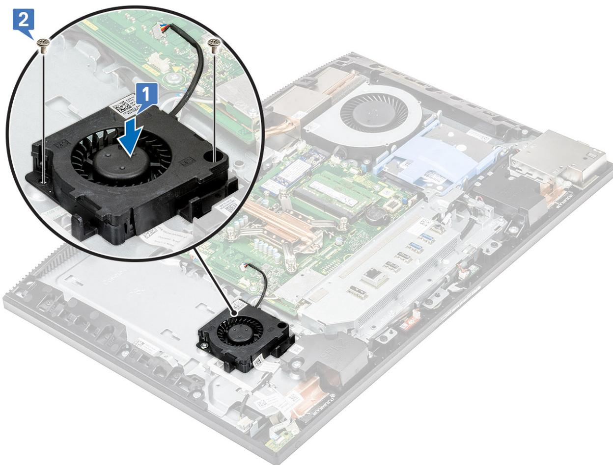
2. Para colocar el cable del ventilador de la PSU:
