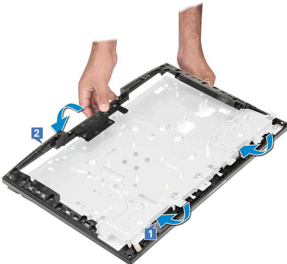
2. Presione y fije las lengüetas de la trama intermedia en las ranuras de la base del ensamblaje de la pantalla [1].
