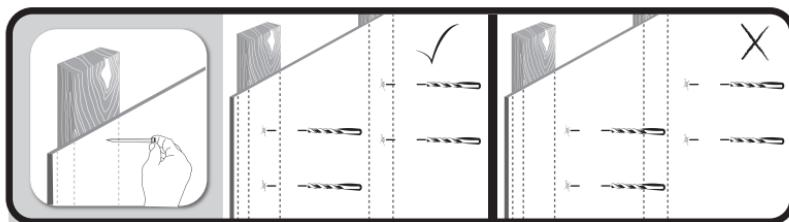
\* Perfore con la broca de 3 mm a una profundidad de 60 mm.
