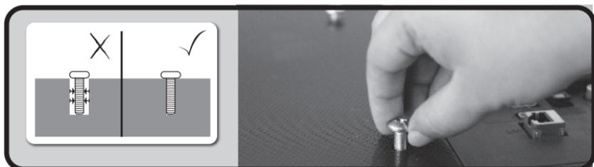
\* Utilice los tornillos adecuados, ya que utilizar tornillos demasiado largos puede dañar los componentes internos de la pantalla.
