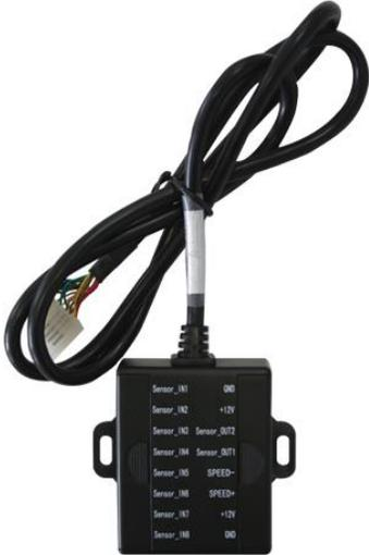
CBALM02 es un dispositivo diseñado para Vigilancia Móvil, de fácil mantenimiento proporciona la interfaz de E/S de entrada de alarma, salida de alarma y la velocidad para las funciones de prueba de alarma y la vinculación de alarma.
