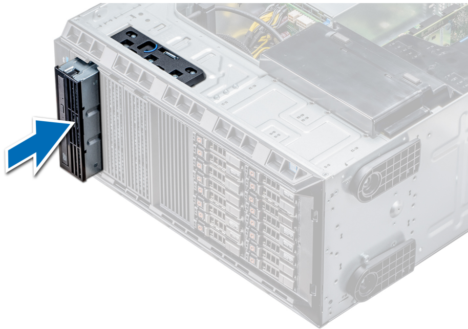
Figura 41. Instalación de la caja de la unidad óptica o la unidad de cinta
