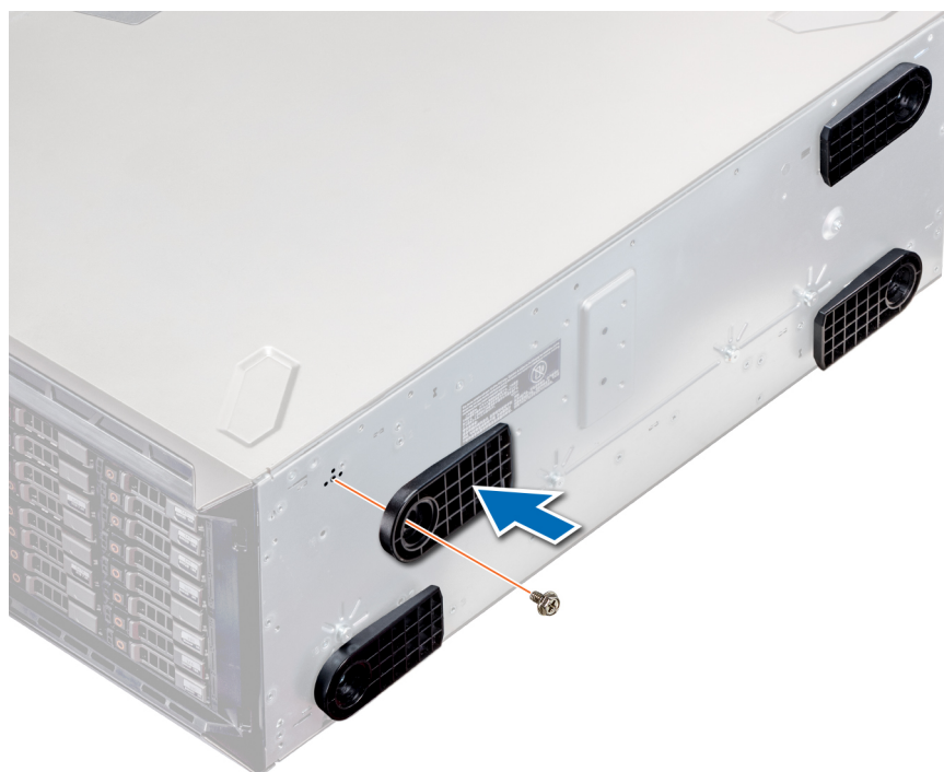
Figura 19. Instalación de los pies del sistema
