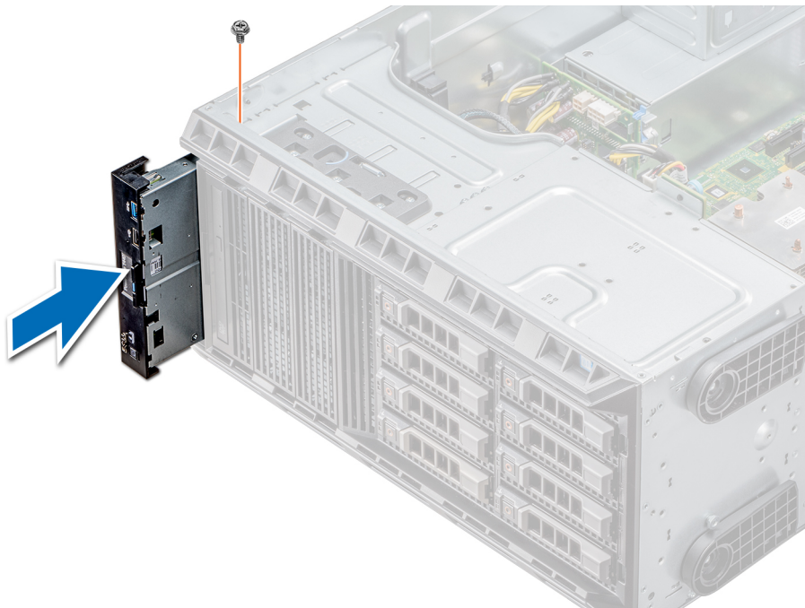
Figura 89. Instalación del ensamblaje del panel de control
