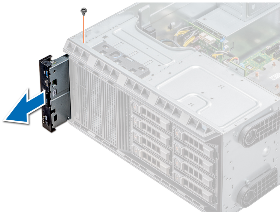
Figura 87. Extracción del ensamblaje del panel de control
