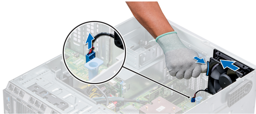
Figura 56. Extracción del ventilador de refrigeración interno
