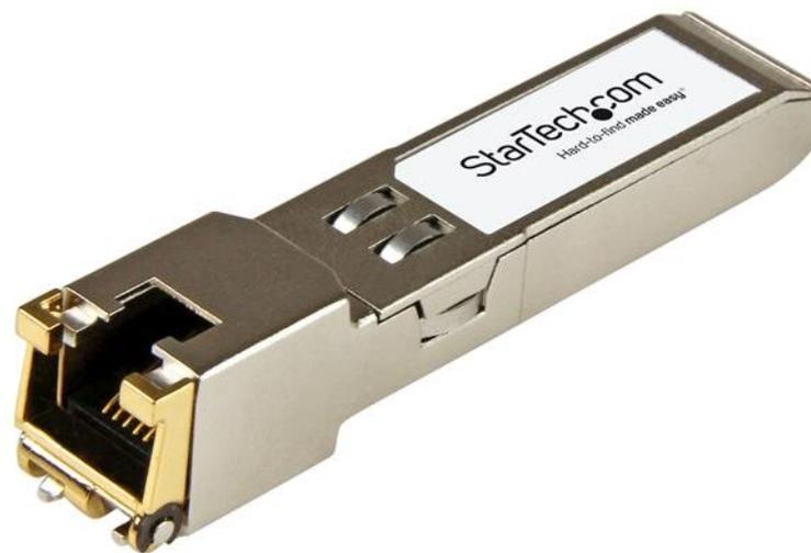
El modelo AR-SFP-1G-T-STSTST es un módulo transceptor SFP por cobre compatible con el modelo SFP-1G-T de Arista Networks diseñado, programado y probado para su funcionamiento con routers y switches de la marca Arista Networks®. Ofrece conectividad confiable a 1 GbE, a través de cable de cobre, para redes compatibles con 10/100/1000Base-TX, a una distancia máxima de hasta 100 m.
