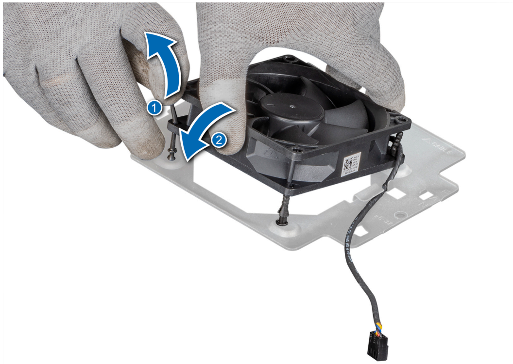
Ilustración 39. Instalación del ventilador del sistema
