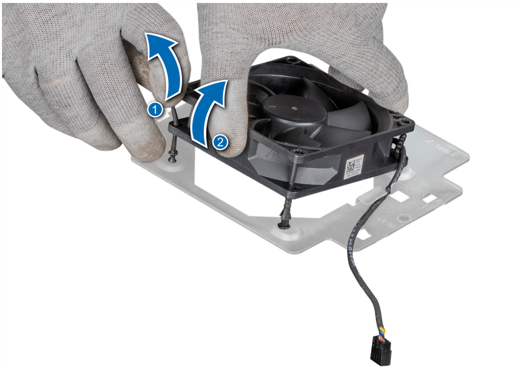
Ilustración 38. Extracción del ventilador del sistema
