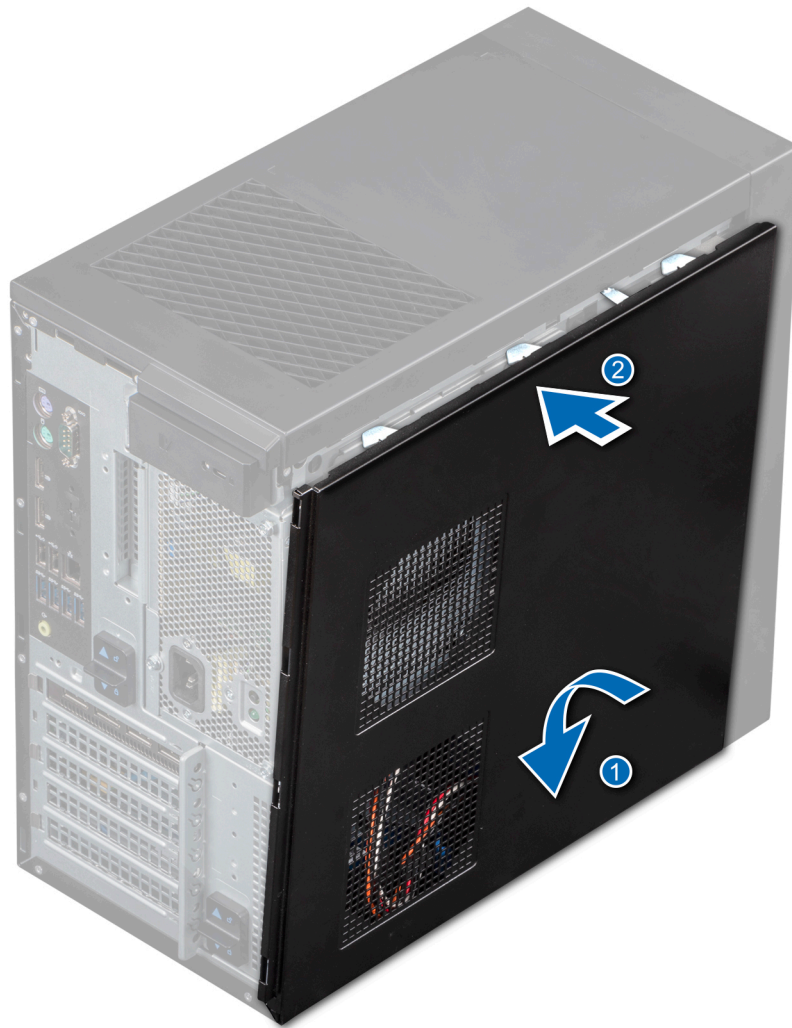
Ilustración 11. Instalación de la cubierta del sistema
