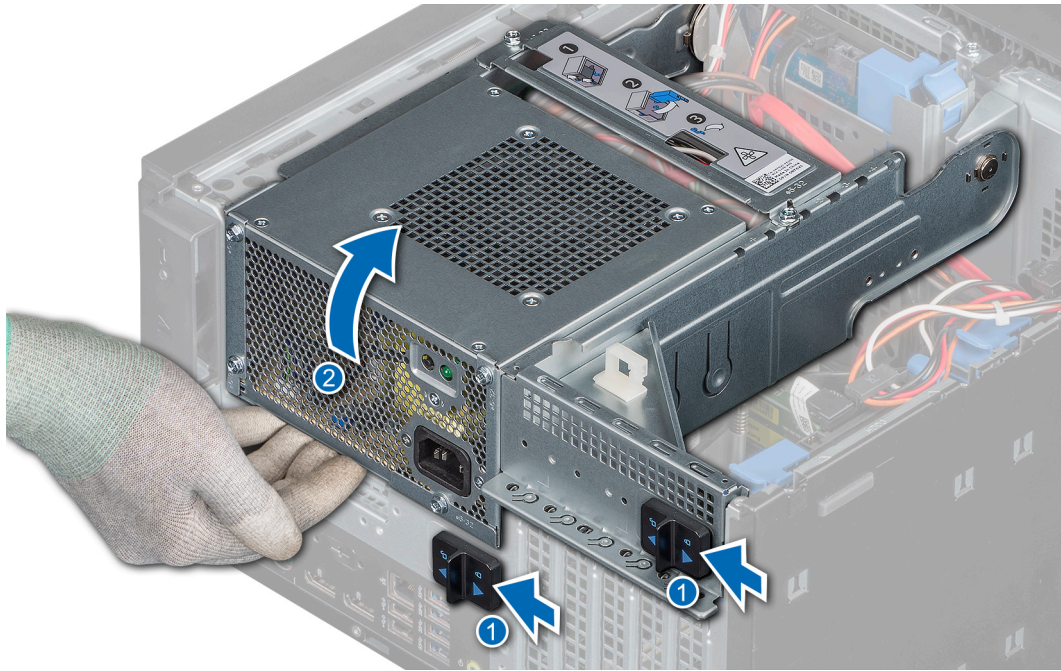
Ilustración 18. Apertura del ensamblaje de la PSU
