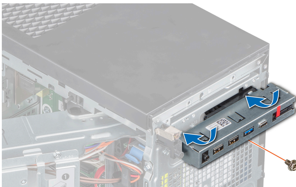
Ilustración 53. Instalación del panel de control
