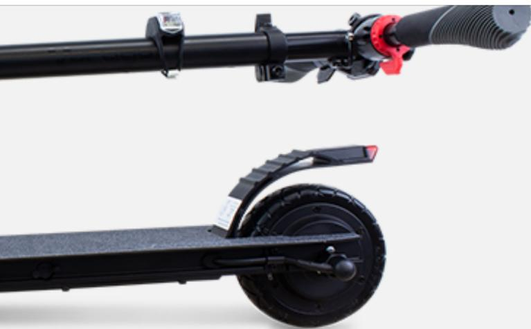
**¡Frena!** En algún momento tendrás que bajar la velocidad, el Kick Scooter cuenta con freno electromagnético en la rueda delantera y freno mecánico en la rueda trasera.
